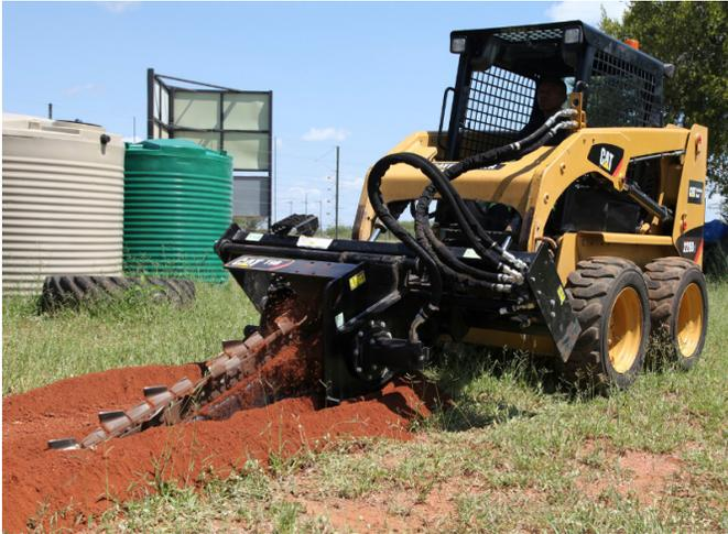
Equipo Zanjador especial para realizar trabajos de Zanjeo para:
